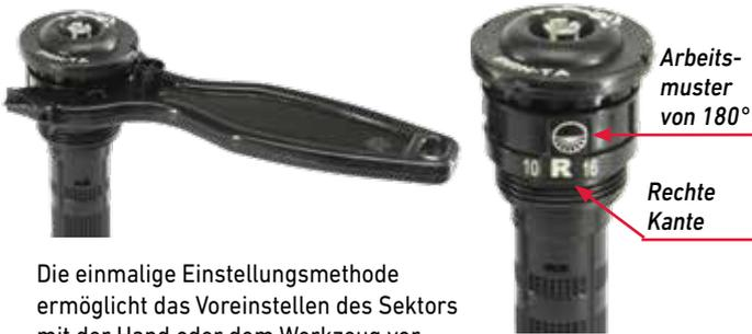
Die einmalige Einstellungsmethode ermöglicht das Voreinstellen des Sektors mit der Hand oder dem Werkzeug vor der Installation der Düse. Mit visuellen Anzeigen kann der Bediener das Sektormuster auf den gewünschten Sektor von 45° bis 270° einstellen. Der Einstellring kann mit der Hand oder dem mitgelieferten Werkzeug eingestellt werden. Das Werkzeug kann separat unter der Bestellnummer PRNTOOL bestellt werden.
