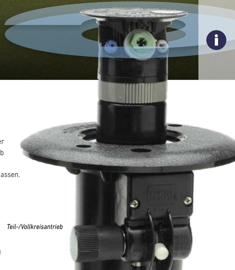
**Die Serie FLEX800 35, 55** hat eine Hauptdüse mit zwei Abwurfwinkeln, die eine ausgezeichnete Düsenleistung in der normalen Winkelstellung von 25° und gute Leistung bei Wind in der Niedrigwinkelstellung von 15° ergibt. Mit dem Teil-/Vollkreisanzug können Sie den Beregnungsbereich einstellen, um die saisonale Beregnung in Sekunden ohne weitere Teile oder Werkzeuge anzupassen.
